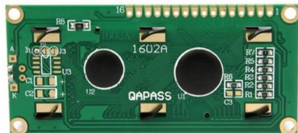
Abbildung 20:LCD HD44780 1602 16x2 - Bild 2
