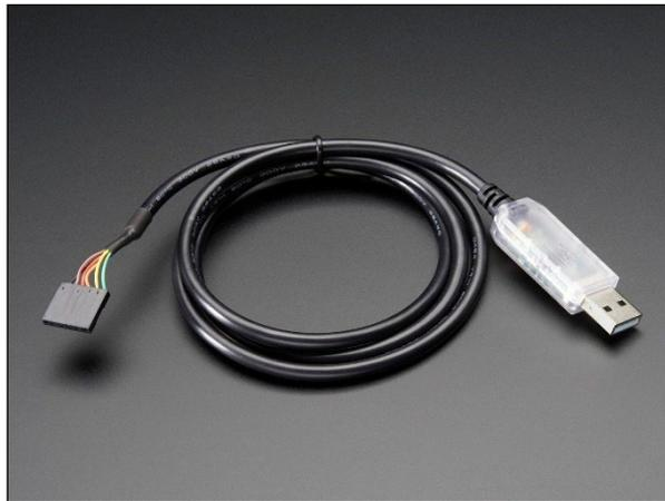
Abbildung 14: FTDI Serial TTL-232 USB Cable
